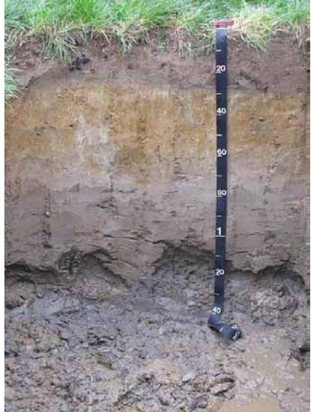
Abb. 3-6: In diesem Gleyboden steht das Grundwasser meistens bis 80 cm unter der Oberfläche (die Grube wurde für das Foto ausgepumpt). Dies ist an der Grenze zwischen dem grauen Horizont, wo meist Sauerstoffarmut herrscht, und dem rostig gefleckten Horizont darüber ablesbar. Die Rostflecken (es handelt sich tatsächlich um Eisenoxide) bildeten sich im Grundwasserschwankungsbereich. Manchmal steht das Grundwasser bis knapp unter der Bodenoberfläche oder es kommt sogar zu Überschwemmungen.
