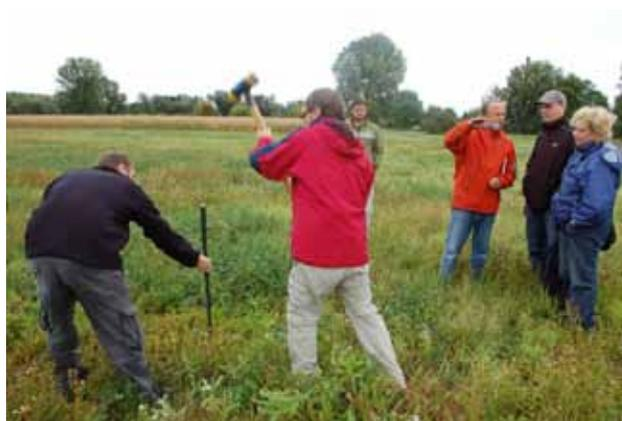
Abb. 5-1: Einschlagen eines Bohrstocks
