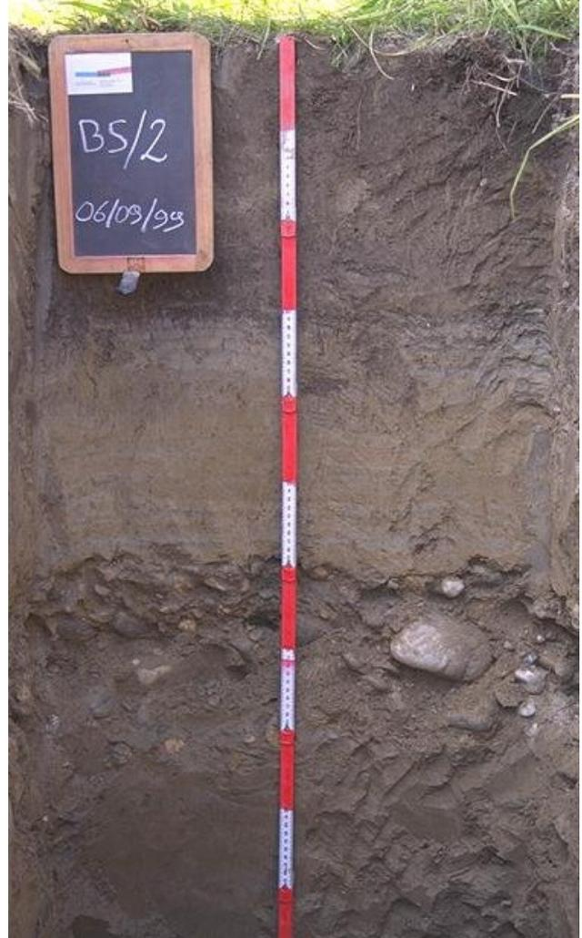
Abb. 3-2: Je nach Strömungsgeschwindigkeit hat hier der Inn bei aufeinanderfolgenden Hochwasserereignissen abwechselnd feines und schottriges Sediment abgelagert. Es entstand ein Auboden.
